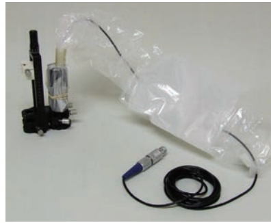
STar™ Drive ve microTargeting™ Drive birimlerine takılmış motor ünitesi
