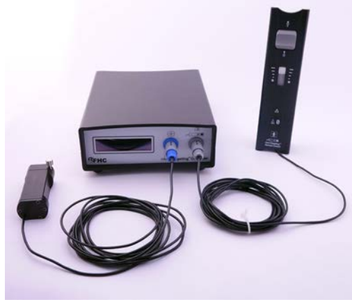
(Izquierda a derecha) Unidad del motor: 66-DA-ME, Módulo de visualización: 66-EL-MS, Mando a distancia: 66-EL-RM
