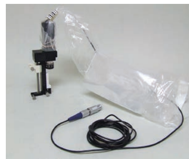
Jednotka motora pripojená k zavádzaču STar™ a zavádzaču microTargeting™
