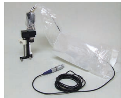
Unità motore collegata all'unità di trasmissione Star™ e all'unità di trasmissione microTargeting™
