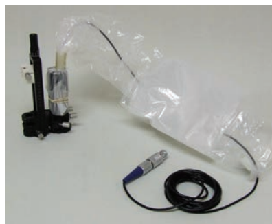
Moteur fixé sur le microdescendeur STar™ et sur le microdescendeur microTargeting™
