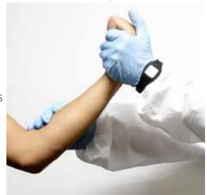
Figure 3. Le capteur de mouvement de test cinétique REX correctement positionné sur le technicien d'essai démontre que le poignet et le coude sont fléchis.
