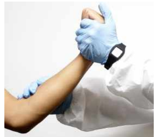
Figura 3. REX El detector de movimiento de prueba cinética que se muestra correctamente colocado en el técnico de prueba demuestra la flexión de muñeca y codo.
