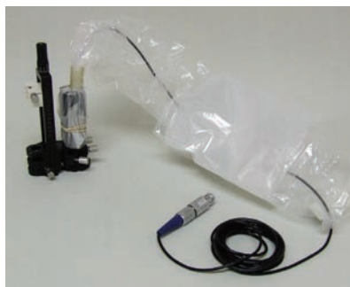
Motorenhed fastgjort til STar™-drev og microTargeting™-drev
