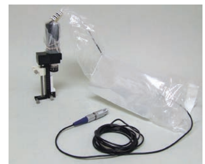
Unitatea motorizată atașată la Sistemul de acționare STar™ Drive și microTargeting™ Drive
