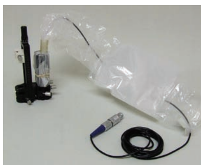
Motorenhet festet til STar™ drivenhet og microTargeting™ drivenhet
