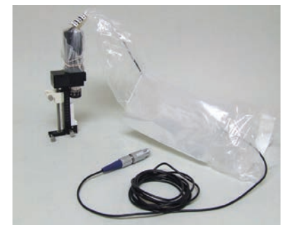
Motoreinheit am STar™ Antrieb und microTargeting™ Antrieb befestigt
