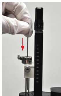
3. Insérer le tube guide/stylet de l'électrode de stimulation dans le canal sélectionné jusqu'à ce qu'il soit complètement enfoncé. Toujours abaisser la poignée du stylet pour s'assurer que le stylet dépasse à l'extrémité distal du tube guide.
